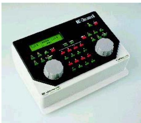
L'IB-CONTROL est un pupitre de commande qui connecté à l'Intellibox par la prise Loconet.. ajoute 2 régulateurs de vitesse et un clavier; IB-CONTROL permet ainsi d'étendre le nombre de poste de pilotage et d'aiguillage du réseau (nombre maximum de poste 6).
